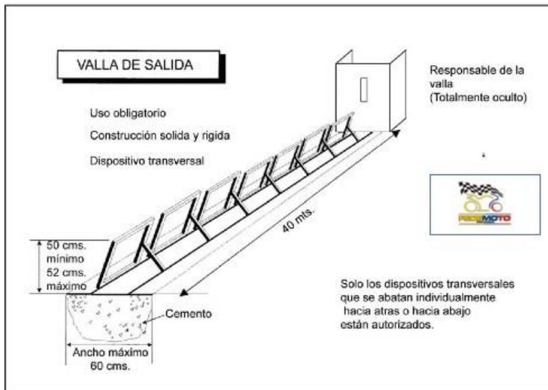
Esta valla de salida debe ser un dispositivo transversal, independiente, que se pliegue o baje hacia el piloto en el momento de su utilización. Debe ser de construcción sólida y rígida y garantizar una seguridad completa. Su funcionamiento será controlado manual o automáticamente.
